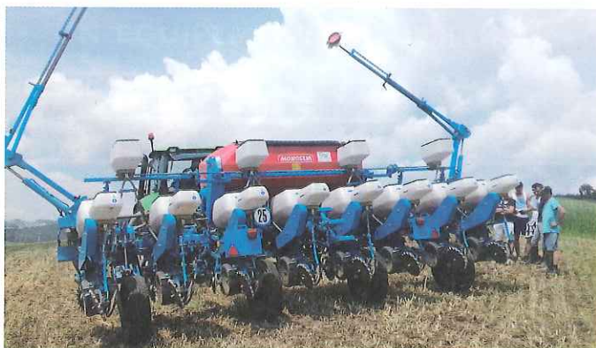
► Présentation des semoirs pour semis direct pour lutter notamment contre les phénomènes d'érosion.
