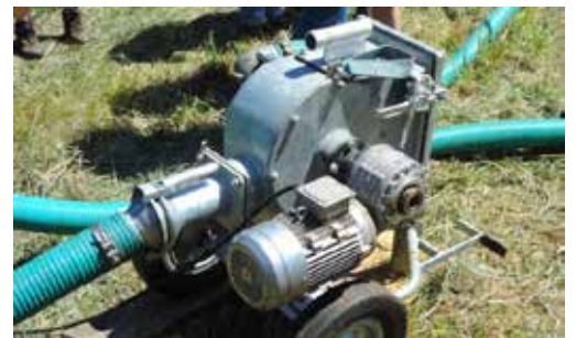
Broyeur en sortie de fosse
