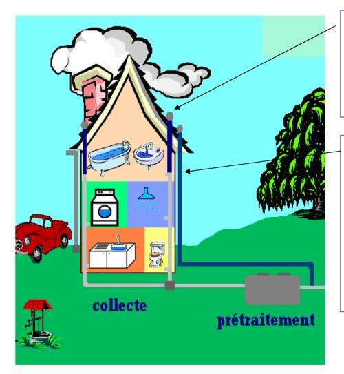
La ventilation primaire permet l'entrée d'air dans le circuit. En général, elle prolonge la canalisation de chute des eaux usées jusqu'en toiture. Avec un champignon.
